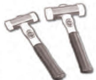
Gummi-Hammer (um eine bessere Abdichtung bei Rohren ab NW 600 zu erreichen)
